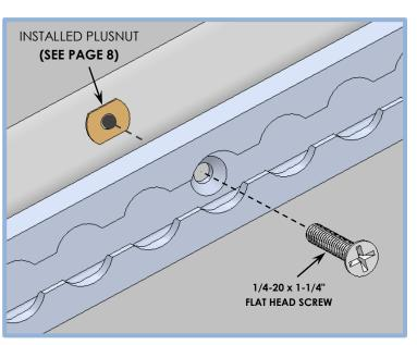
ATTACH L-TRACK AS SHOWN USING:
